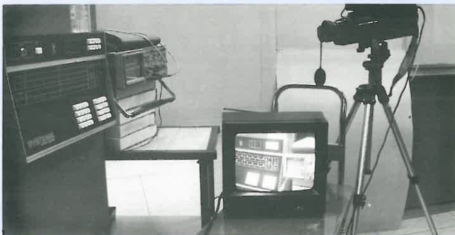
Videokameran övervakar en CPU 1 panel tillsammans med en signal på oscilloscopet
